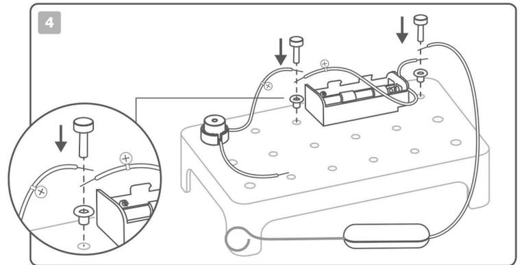
3. Fissare il vano batteria sulla piattaforma. Fissare il cicalino sulla piattaforma di fianco al vano batteria.
