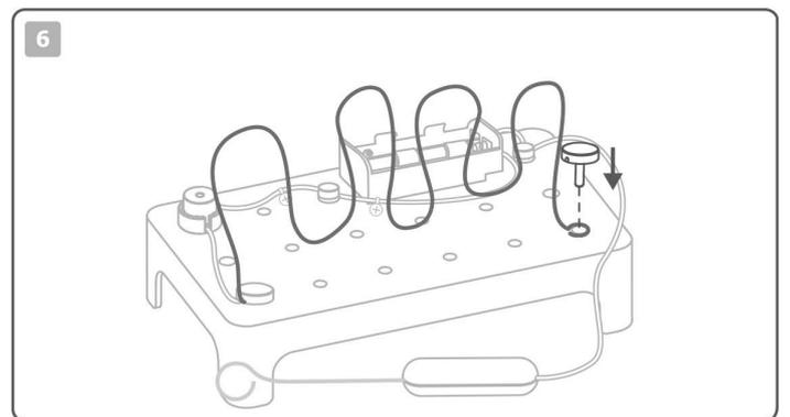
5. Piegare il resto del filo metallico in qualsiasi forma. Il filo modellato deve coprire una lunghezza di circa 15 cm. Fissare il filo rimanente del cicalino a un'estremità del filo metallico modellato. Avvolgere l'estremità del filo metallico intorno al perno di un chiodino in plastica grande. Fissarlo sulla piattaforma di fianco al cicalino.
